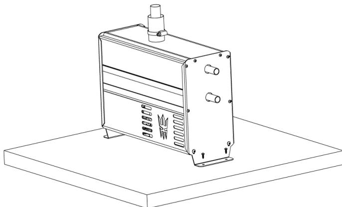
Värmaren kan installeras på golvet med hjälp av monteringsfötter. Fäst enheten på ett plant och stabilt underlag yta som inte lutar mer än 5 grader från det horisontella planet. Medan enheten kanske inte går sönder om den tillfälligt lutar till en brant vinkel (även under några timmar), kan brännaren inte ge optimal prestanda om den är ständigt lutar. Monteringsfötter och nödvändiga skruvar finns i tillbehörspåsen.
