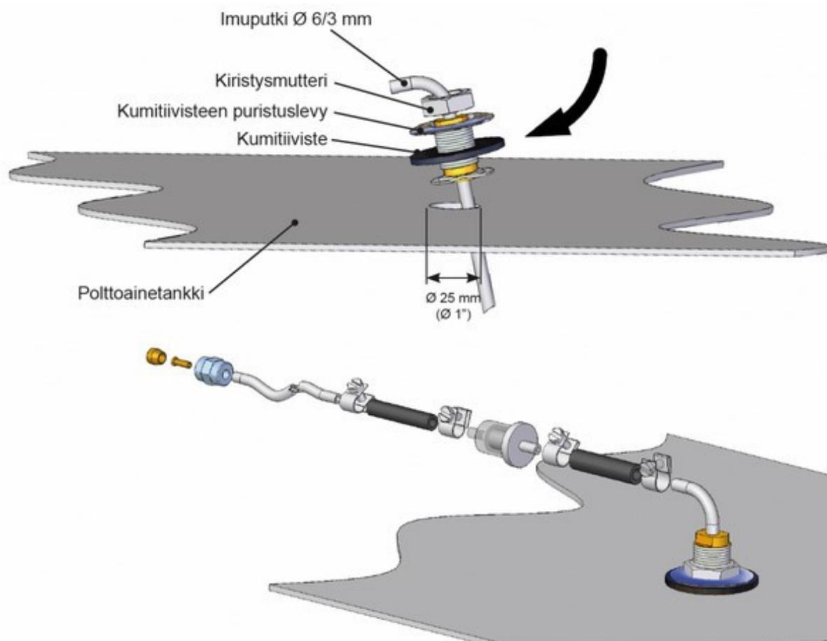
1. Polttoainetankin yläpintaan tehdään  $\varnothing 25$  mm reikä. Valitse reiän paikka siten, että polttoainetankin kallistuessa polttoaineen imuputken pää jää polttoaineeseen vaikka polttoainesäiliö on vajaana. Mikäli imuputken pää ei ylety polttoaineeseen, laite sammuu hetken kuluttua polttoainejärjestelmässä olevaan ilmaan.
