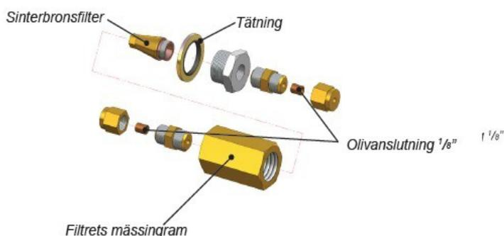
Används i länder var det krävs ett överföringssystem av metall för bränslet. Vid installation används ett 1/8 "metallrör.
