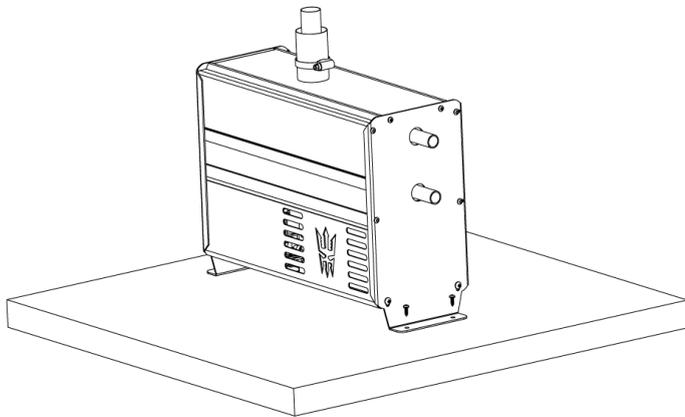
Lämmitin voidaan asentaa lattiaan "jalcojen" avulla. Kiinnitä laite tasaiselle vakaalle alustalle, joka ei ole kallistettu enempää kuin 5 astetta vaakatasosta. Vaikka laite ei välttämättä hajoa, jos se on tilapäisesti kallistettu jyrkästi (jopa muutaman tunnin ajan), polttimen suorituskyky ei ole optimaalinen, jos se on jatkuvasti kallistettuna. "Jalat" ja tarvittavat ruuvit löytyvät tarvikkepussista
