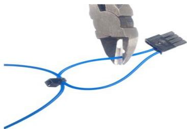
Paikanna sininen "Enable" johtosilmukka, joka on kytketty lämmitin pohjaan. Katkaise toinen johdoista liittimen läheltä ja liitä se pääkytkimen + 12V napaan.
