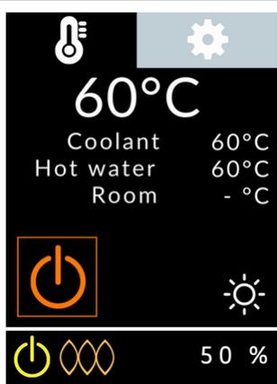
**Vaihtoehto 2** Laitteen voi sammuttaa myös siirtämällä osanssi neliö **nuolinäppäimillä** **On/Off kuvakkeen** kohdalle ja painamalla **Valinta-näppäintä**.
