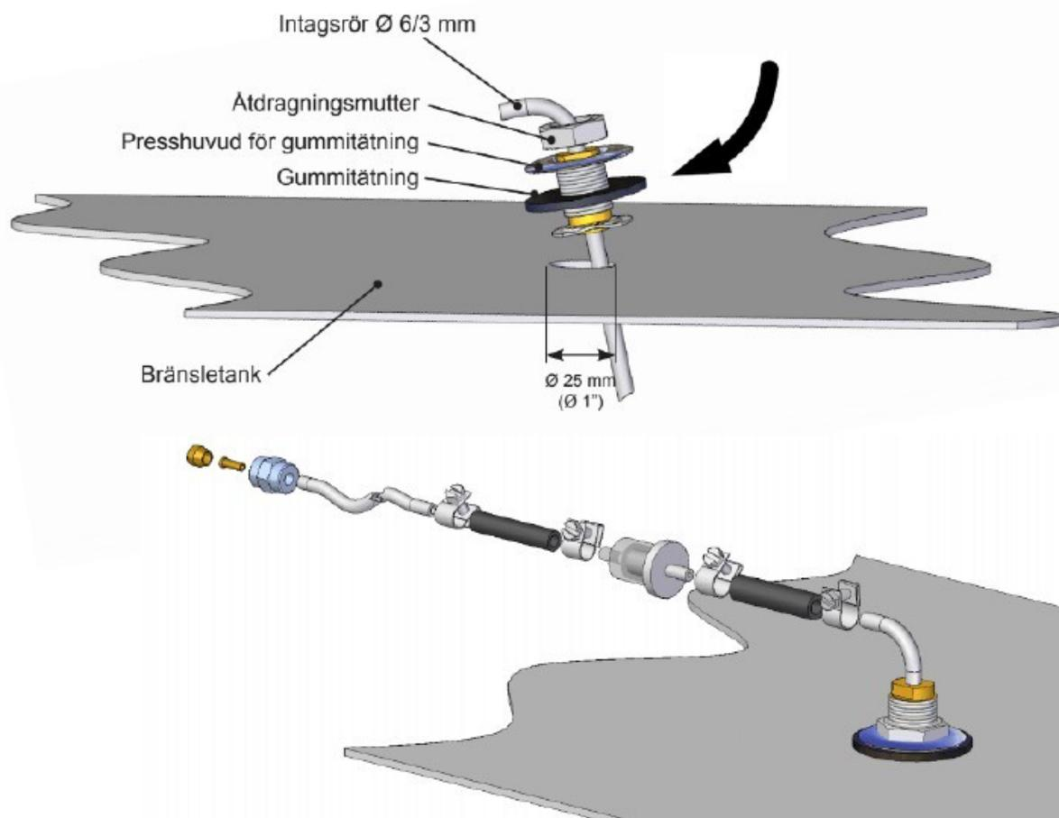
1. Först görs ett  $\varnothing 25$  mm hål på toppen av bränsletanken. Välj hålets läge så att då bränsletanken lutar kommer inloppsrörets ända att hållas i bränslet även om tanken är inte full. Om inloppsrörets ända inte når bränslet, kommer enheten snabbt att avstängas av luften i bränslesystemet.
