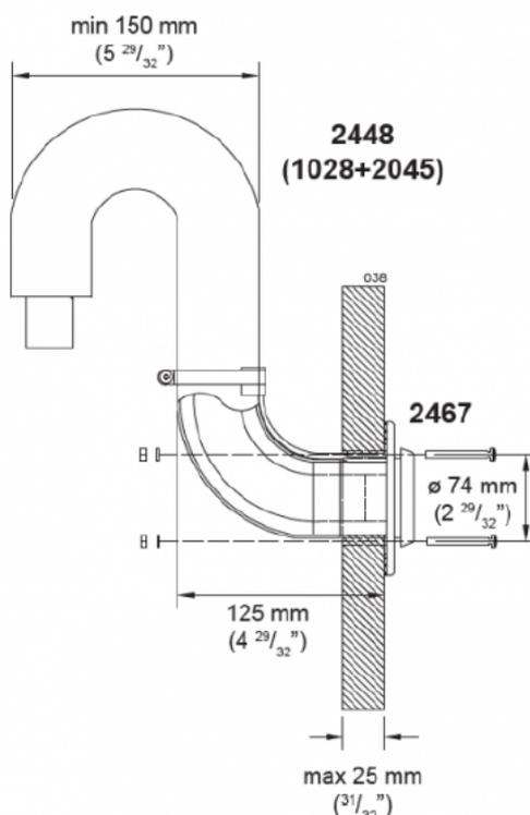
Savukaasun poistoputken **1028** pitää olla 30-50 mm pidempi kuin paloilmän imuputki **2045**. Näin varmistetaan savukaasuputken paikallaan pysyminen läpiviennissä. Mitta riippuu putkiston kokonaispituudesta.
